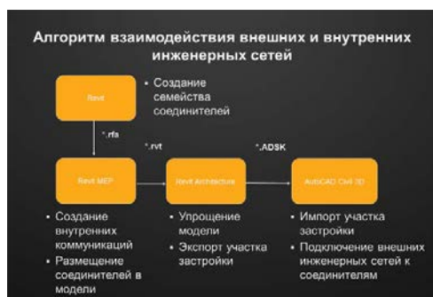
Рис. 4. Файл обмена архитектурными данными позволяет экспортировать из Revit алгоритм подключения внешних и внутренних инженерных сетей
