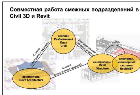
Рис. 11. Алгоритм передачи задания строительному отделу от отдела генплана и дорог с помощью внешних ссылок
